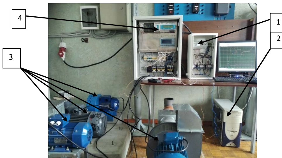
Рис.2 – Общий вид экспериментального стенда для исследования влияния очередности запуска электродвигателей на выходные показатели системы: 1 – регистратор; 2 – ноутбук; 3 – электродвигатели; 4 – программируемый логический контроллер.
