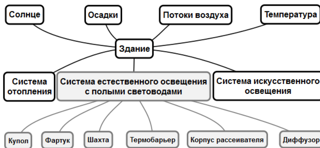
Рисунок 3 – Структурная модель системы естественного освещения помещения с полыми световодами
