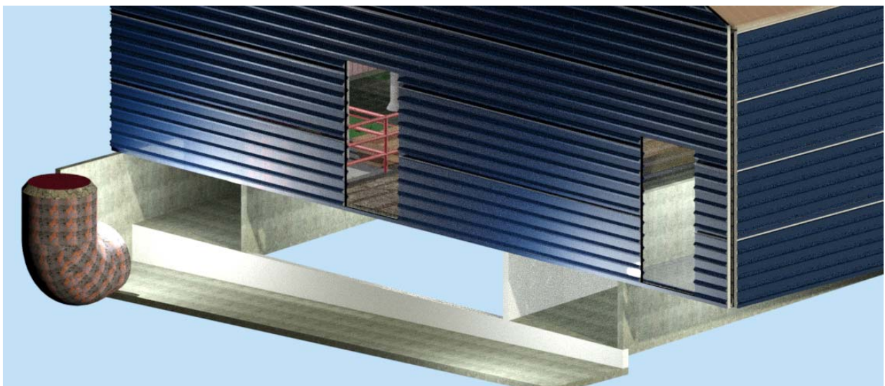
Рисунок 5 - Поперечный и продольные каналы для навозоудаления и сливная яма
