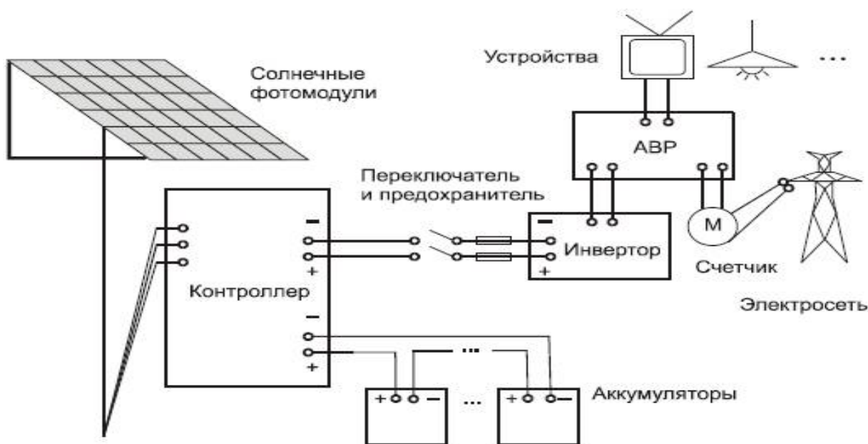
Рисунок 1 Структурная схема подключения потребителя к гибричному источнику электроэнергии
