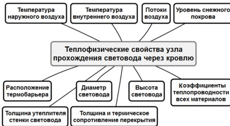
Рисунок 5 – Структура внешних и внутренних факторов системы влияющих на теплофизические свойства узла прохождения световода через кровлю
