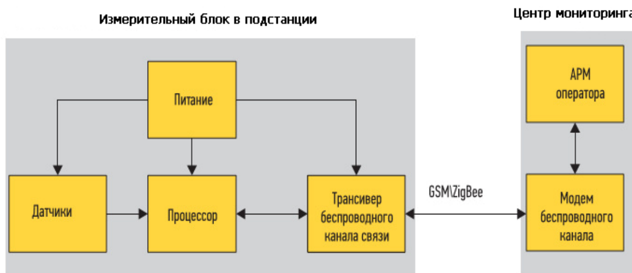
Рис. 1. Устройство системы мониторинга и передачи данных
