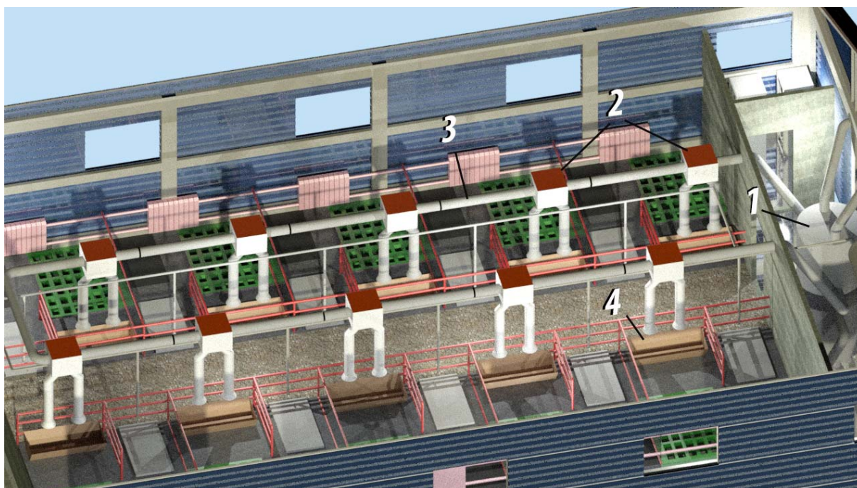
Рисунок 3. - Модель кормораздаточного агрегата (1- ёмкость для смешивания, 2- дозаторы корма, 3- трубопровод с шайботросом, 4- кормушка).
